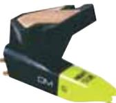
Cellule professionnelle. Echancre dans la partie avant du corps et extrémité fluo pour faciliter le positionnement. Diamant sphérique. Grande fidélité de restitution des timbres. Système de montage standard 1/2". Robuste et fiable en usage intensif. Tension de sortie élevée. Particulièrement adaptée pour l'électro et clubs.
